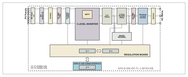
Figure 7 : Block diagrams PVSA-EE
