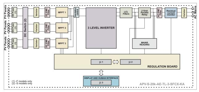
Figure 6 : Block diagrams PVSA-AE
