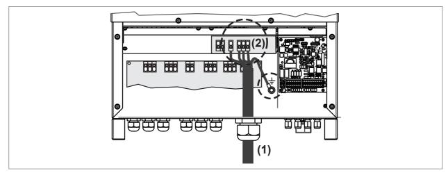
Figure 17 : AC connection (PVSA-EE-... models)
