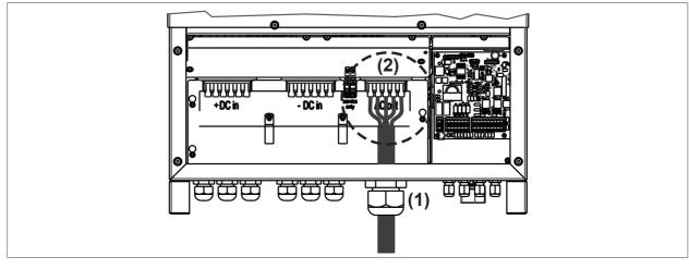
Figure 16 : <u>AC connection (PVSA-AE-... models)</u>
